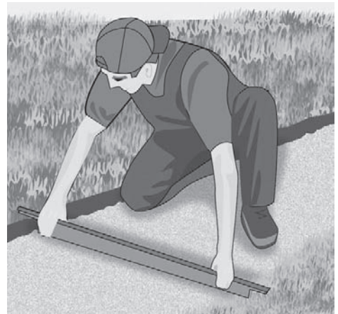
Рис. 3.9. Выравнивание песка рейкой
