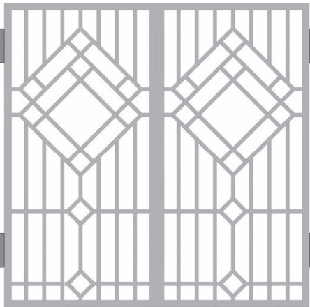
Рис. 6.14. Металлические решетчатые ставни
