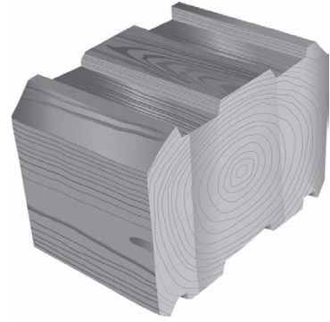
Рис. 4.2. Фрагмент клееного профилированного бруса
