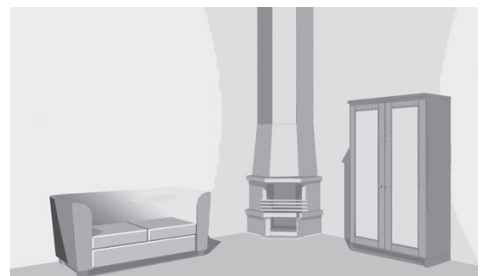
Рис. 10.14. Угловой камин с пристроенным дымоходом
