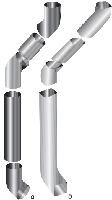
Рис. 5.30. Сечения водосточных труб: а — круглое; б — квадратное
