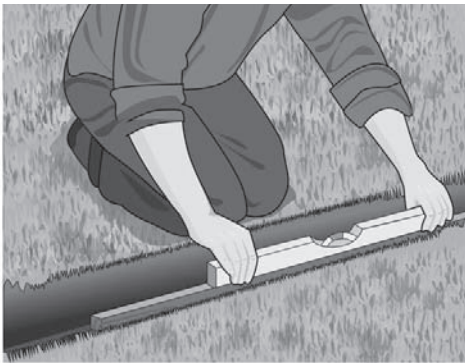
Рис. 2.5. Проверка траншеи под дренаж уровнем
