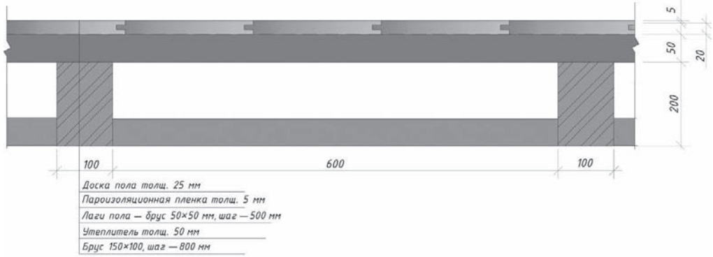
Рис. 5.3. Конструкция перекрытия по несущим балкам
